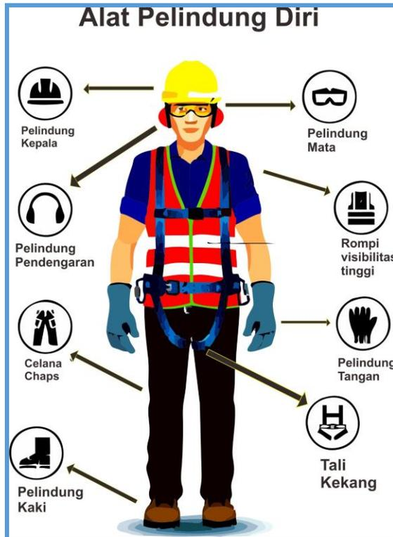
Gambar 1.19. Kelengkapan Alat Pelindung Diri (APD)
